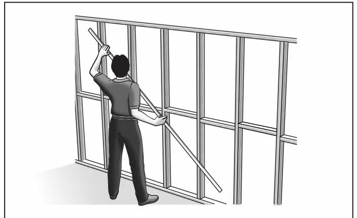
FIGURE 1 FRAME STRAIGHTNESS
